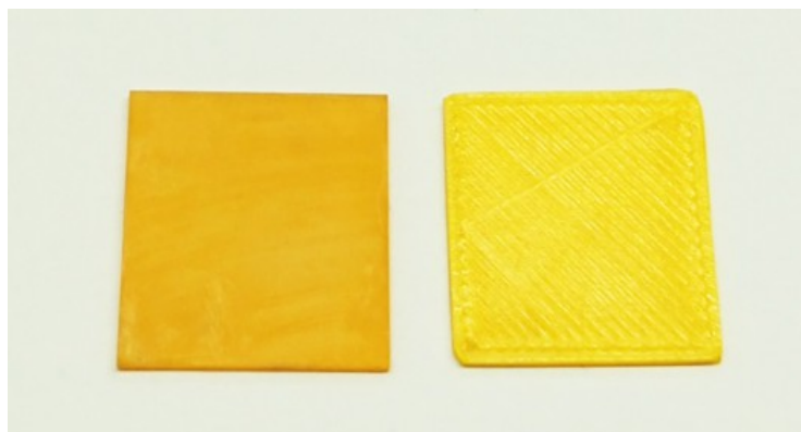
Рисунок 3.8. Ліворуч: монокристал \text{ZnSe:Al} . Праворуч: 3D друкований сцинтилятор із гранулами \text{ZnSe:Al} .
