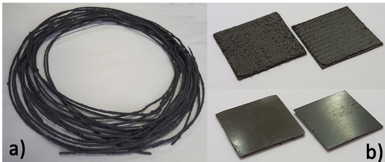
Рисунок 4.4. а) Виготовлений філамент композиційного матеріалу на основі пластикового сполучного TPU з наповнювачем металевого порошку вольфраму (W) та б) зразки, ним надруковані
