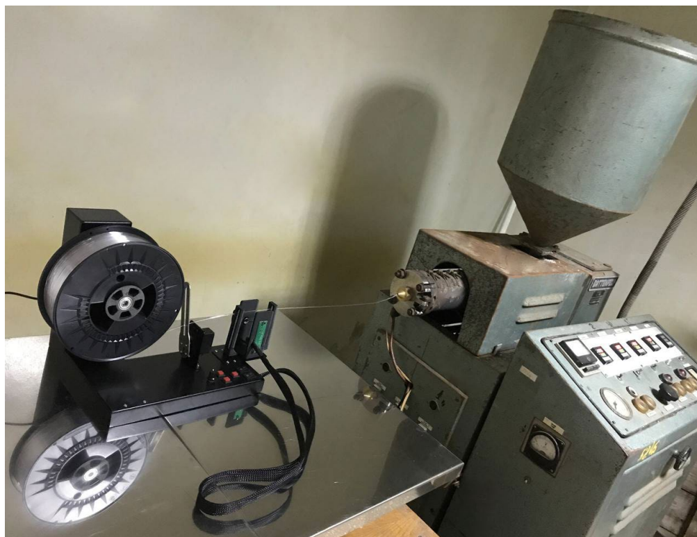
Рисунок 5.2. Отримання світлопровідного філаменту з полістиролу.
