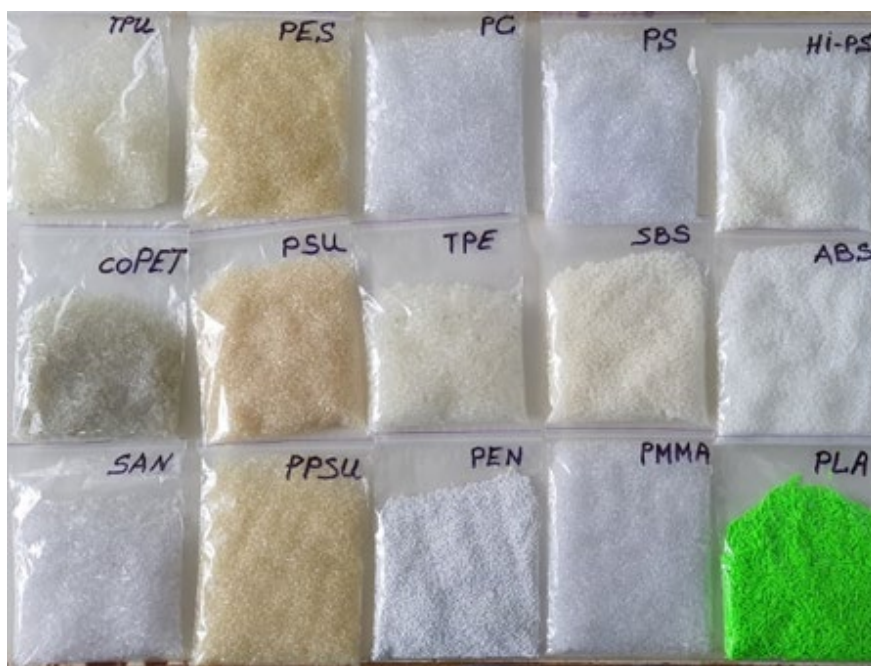
Рисунок 4.2. Вибір термопластичних полімерів для сполучника композиційного матеріалу абсорберу.
