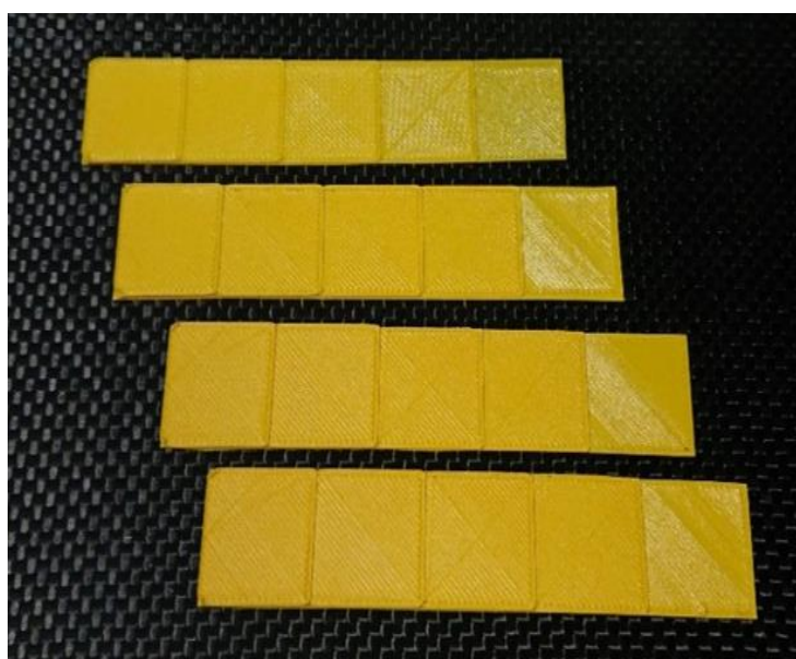
Рисунок 3.7. 3D-друковані сцинтилятори з гранулами ZnSe:Al.
