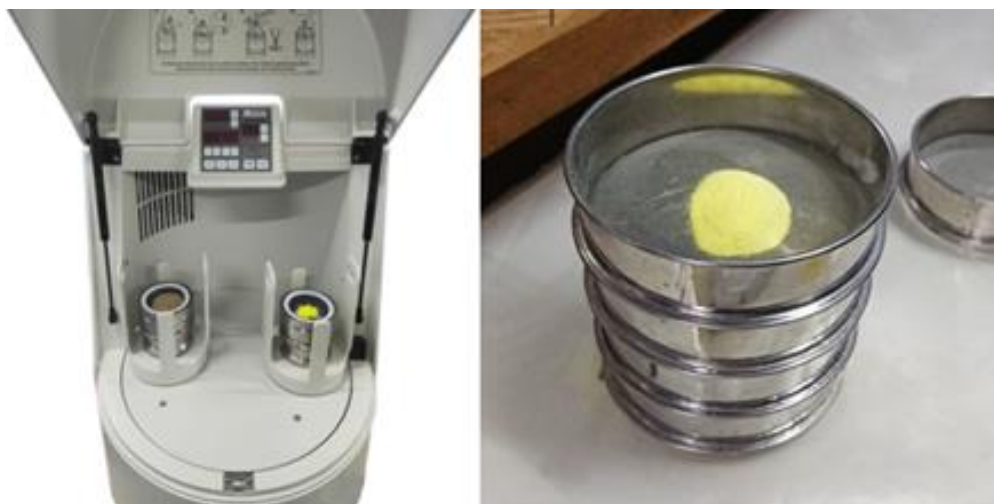
Рисунок 3.1. Ліворуч: Планетарний млин Fritsch Pulverisette 5/2; Праворуч: набір сит для фракціонування неорганічних сцинтиляційних гранул
