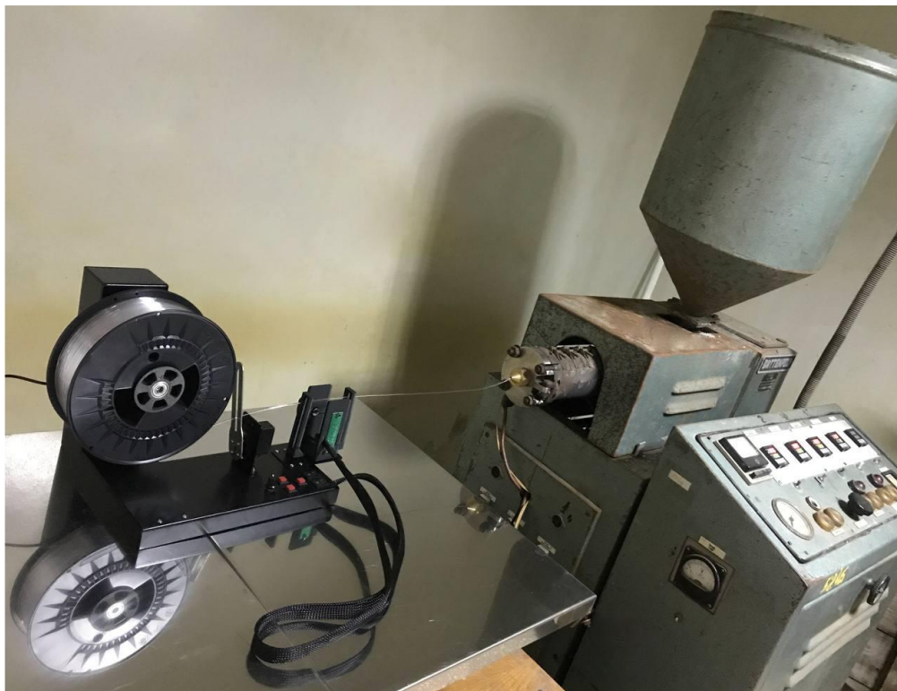
Рисунок 5.2. Отримання світлопровідного філаменту з полістиролу.
