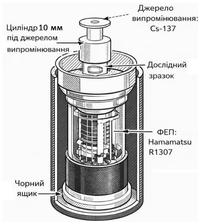
Рисунок 2.5. Збірка обладнання для вимірювання світлового виходу.
