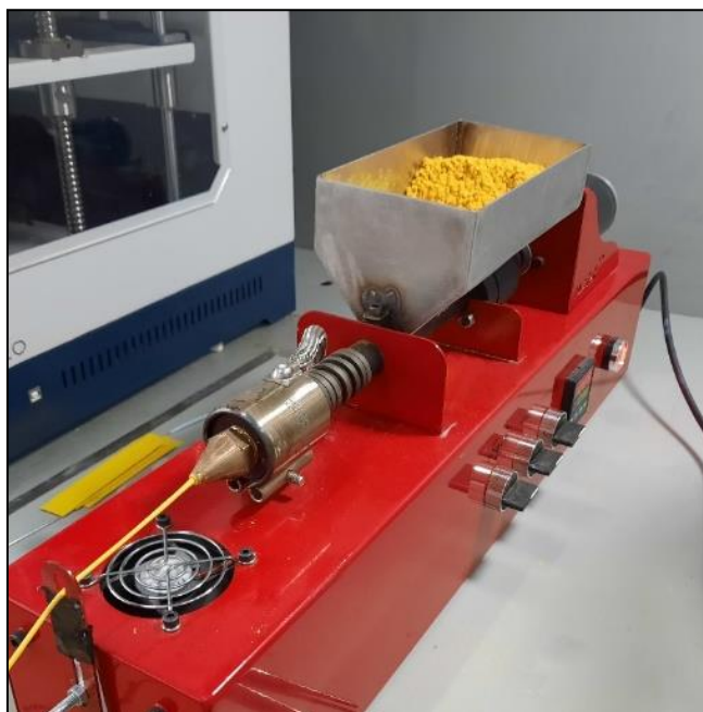
Рисунок 2.1. Процес отримання скінтіляційного філаменту з ZnSe:Al на екструдері Noztek Pro HT
