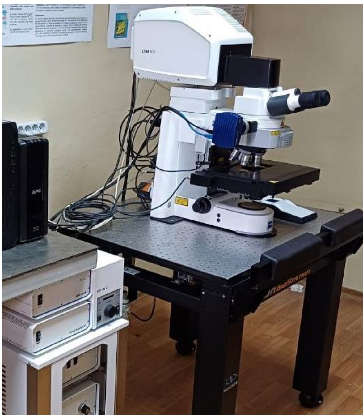
Рис. 2.6. Конфокальний лазерний скануючий мікроскоп ZEISS LSM 900.
