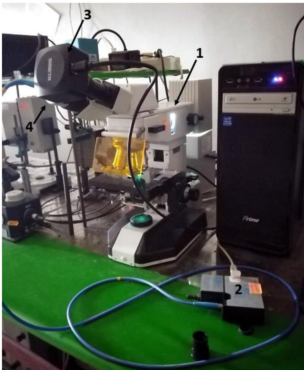
Рис. 2.1. Люмінесцентний мікроскоп Мікмед-2 (1) сполучений з мікроспектрометром USB4000 і цифровою камерою SIGETA. 4 – оптоволоконний адаптер для окуляра.
