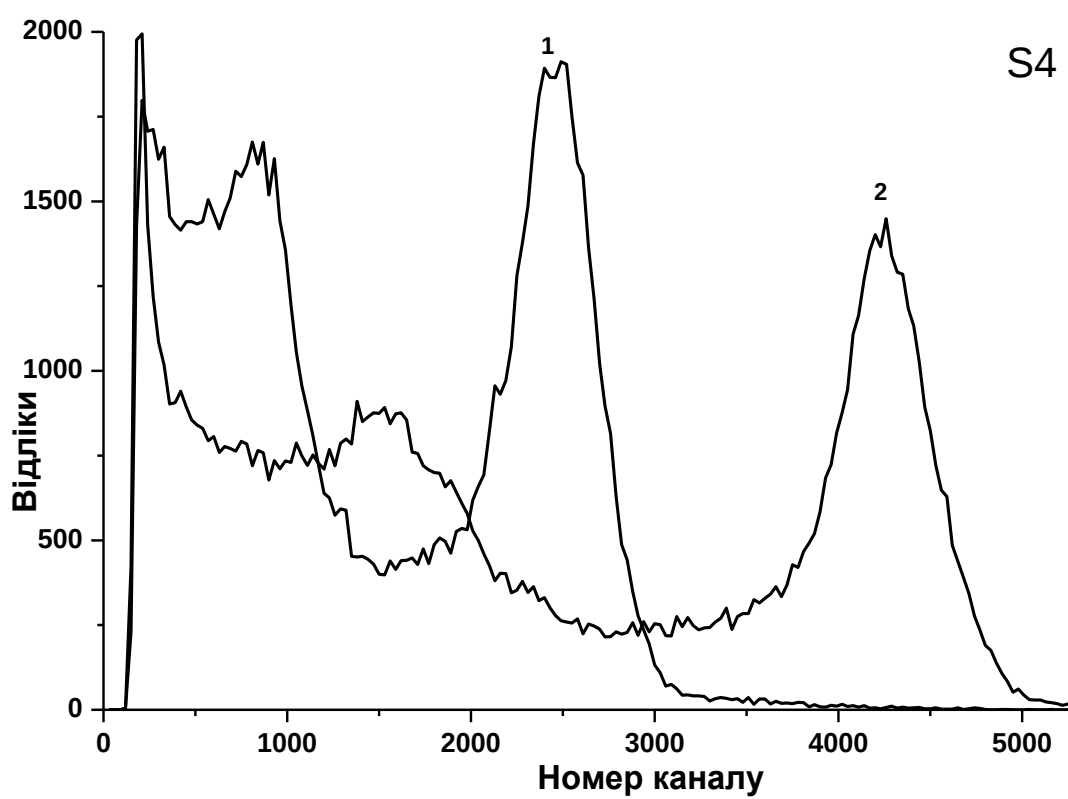
Рисунок 5.5 – Амплітудно-сцинтиляційні спектри зразків ПС S3 і S4 до (1) і після (2) опромінення дозою 10 Мрад
